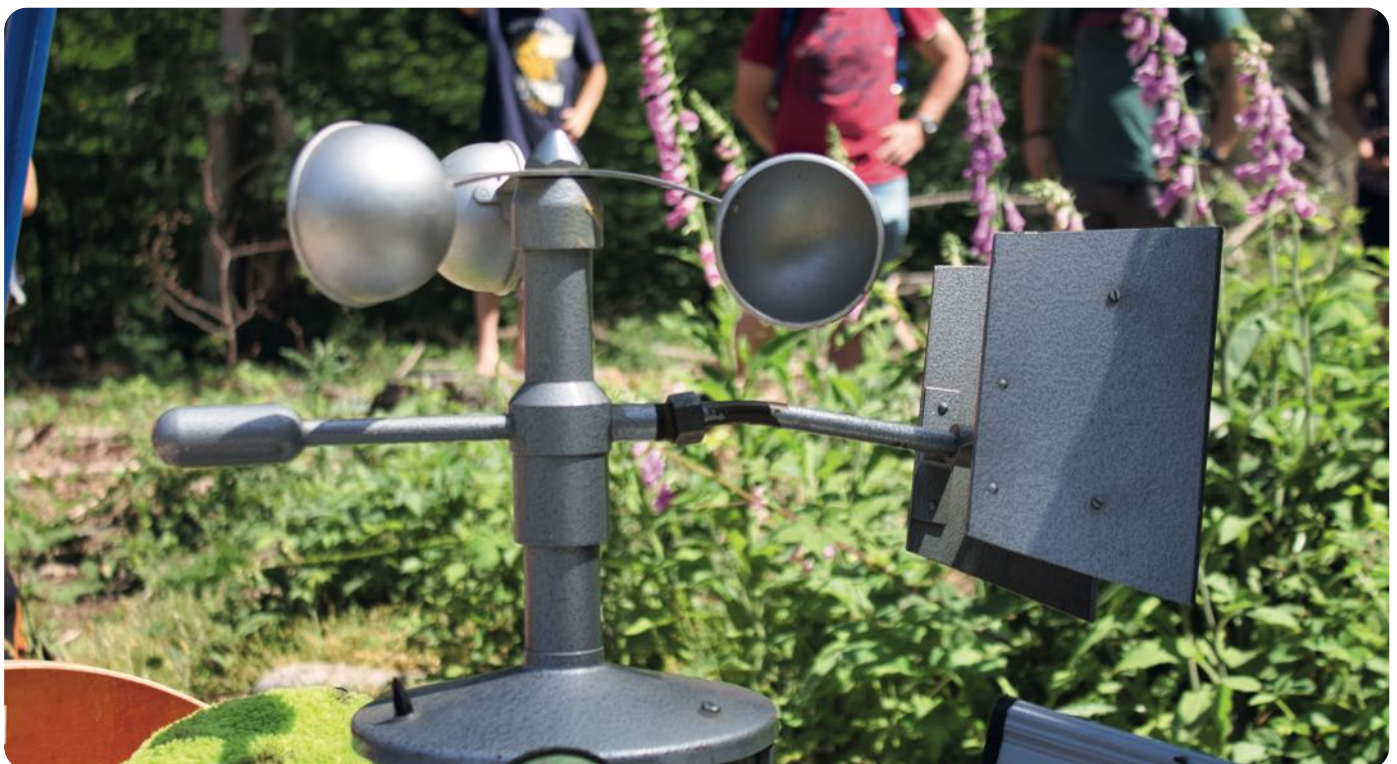
WINDMESSGERÄT: ZUM ERFASSEN VON WINDSTÄRKE UND WINDRICHTUNG
